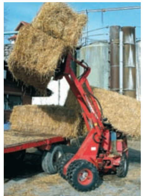
Accident avec un chargeur compact sans protection FOPS (structure de protection contre la chute d'objet). (Photo reconstitution: SPAA)
