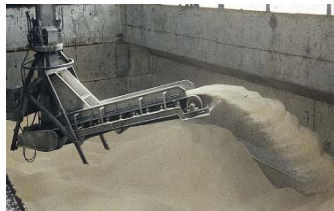
Le projeteur à céréales n'est pas adapté à la manutention des engrais.
