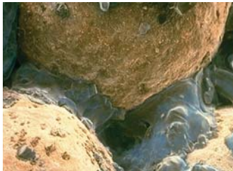
Ponts cristallins entre particules entraînant le mottage.
