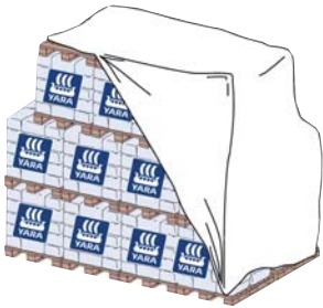
Stockage et protection des sacs palettisés.
