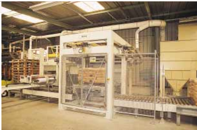
Palettiseur automatique de sac de farine de silice
