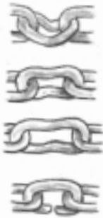
Chaînes usées ou en mauvais état
