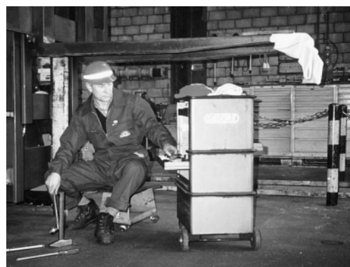
figure 7: lors de travaux d'entretien sous les fourches, il y a lieu de les caler et de signaler la position relevée de celles-ci.
