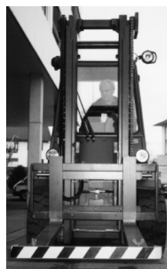
Figure 6: lorsqu'un chariot doit emprunter la voie publique, il est à équiper selon la loi sur la circulation routière.
