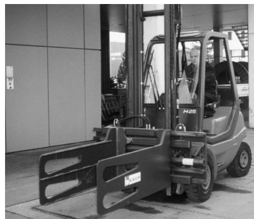
Figure 3: pour chaque activité il y a lieu d'utiliser un porte-charge adapté comme, par exemple, une pince à balles.
