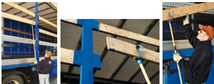
Outil pour le démontage des planches latérales de remorque
