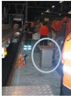
Mise à hauteur à l'aide d'une rehausse
