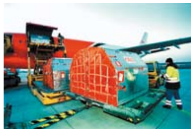
Chargement automatique des ULD dans l'avion
