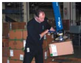
Aide au levage par aspiration
