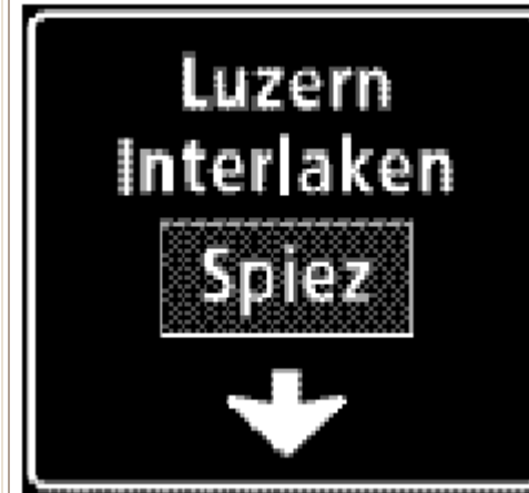
4.69 Panneau de présélection au-dessus d'une voie de circulation sur autoroute et semi-autoroute (art. 86 et 87)
